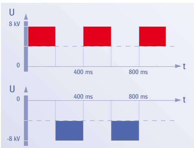
Bei den gepulsten DC-Systemen liegt eine gepulste Gleichhochspannung an, die an den Spitzen mit positiver Spannung positive Ionen (roter Bereich) und an denen mit negativer Spannung negative Ionen (blauer Bereich) erzeugt. Die beiden Spitzenarten sind im Ionisator jeweils im Wechsel angeordnet. Die Frequenz ist einstellbar. Die Höhe der Hochspannung ist abhängig vom Typ.
